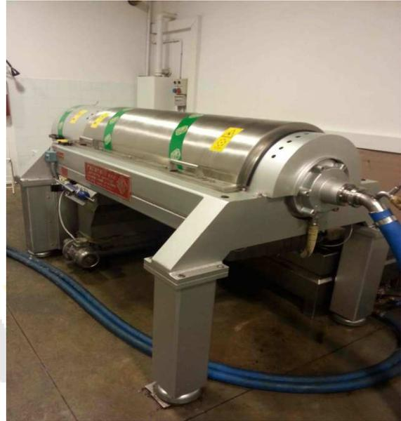
Abbildung 12 Zentrifuge - Extraktion des Öls
