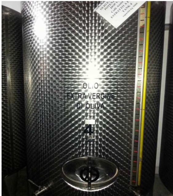
Abbildung 13 Tank mit Stickstoff aufgefüllt
